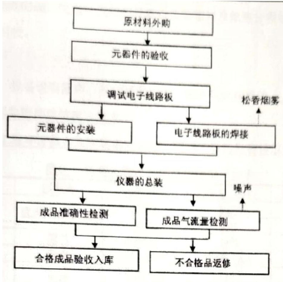
图 2.1-1 CJZ70 瓦斯抽放综合参数测定仪工艺流程及产污环节示意图
