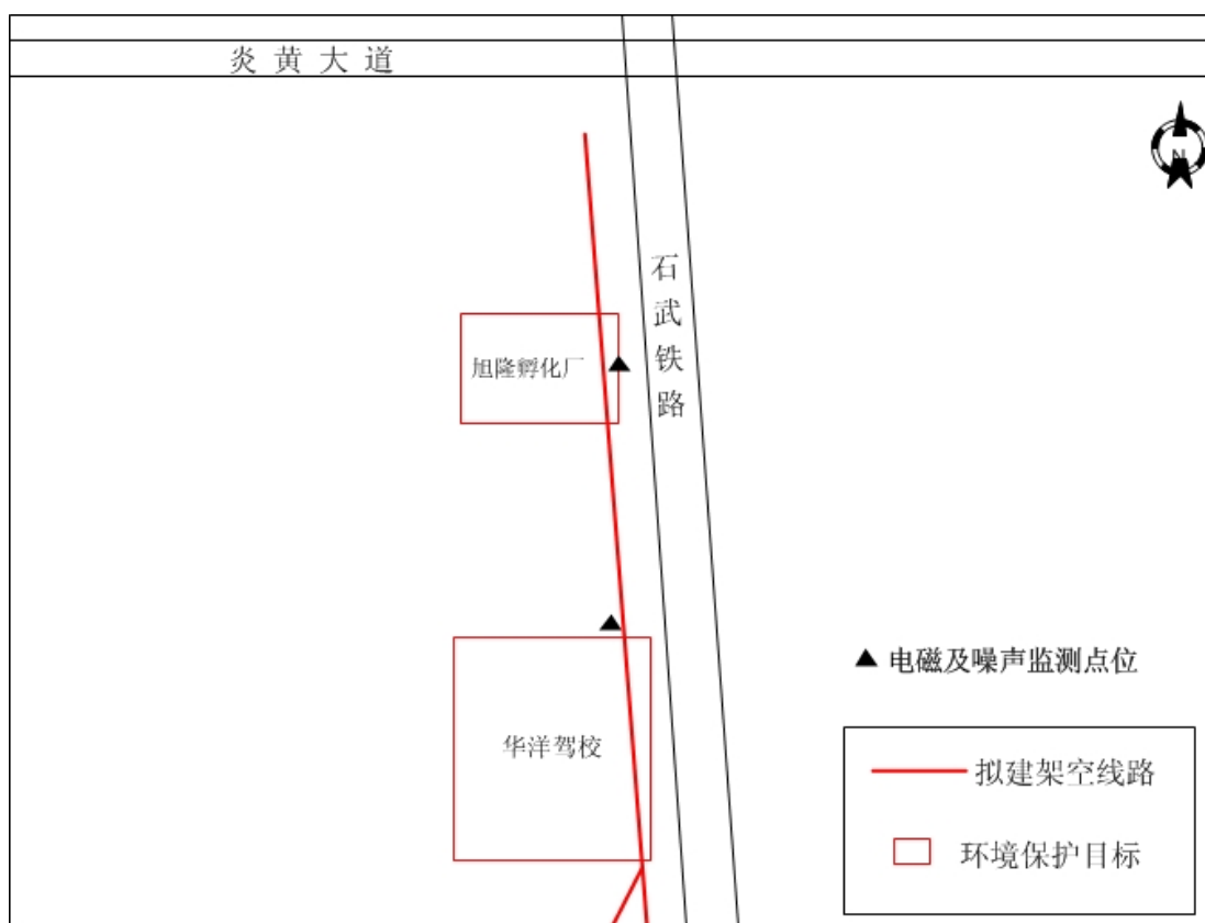
图 7-4 110 千伏河西输变电工程监测点位布置示意图
