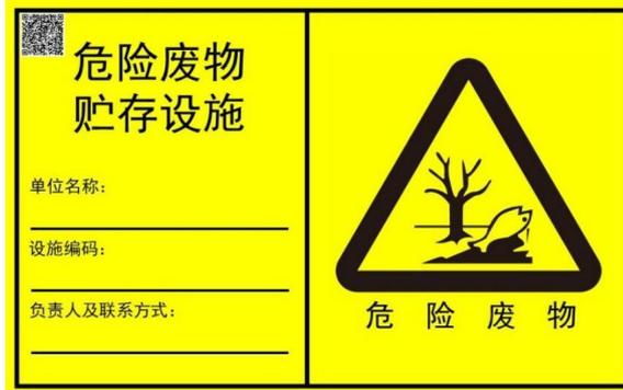
图 4-3 横版危险废物贮存设施标志样式示意图
